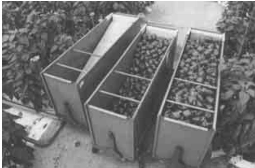
Fig. 1.10 Een beweegbare bodem is een manier om de valhoogte van vruchten te verkleinen. Hier zie je een voorbeeld van een paprikaoogstkar.
